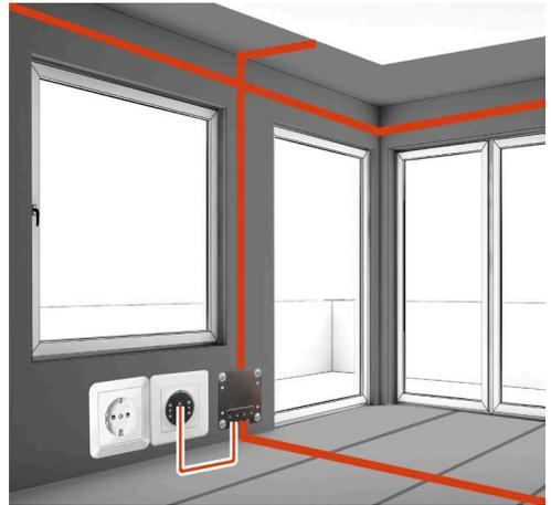
Grundsätzliches Vorgehen: Ausgehend von einem zentralen Erdungspunkt GF2, GF3, GF4, GS1, GS2, GS3 müssen **alle Flächen einmal durchquert und miteinander verbunden** werden. Wenn keine Türen im Weg sind, kann das Band unter der Sockelleiste verklebt werden.
